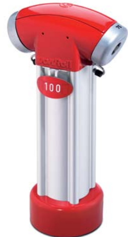
Fig. 5602 2 Seitenabgänge wahlweise 2x75, 2x55 oder 75/55 Storz Gewicht 24 kg
